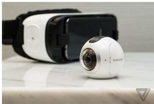
شکل ۱) دوربین سامسونگ Gear 360 2016 و هدست مخصوص نمایش فیلم ۳۶۰ درجه
