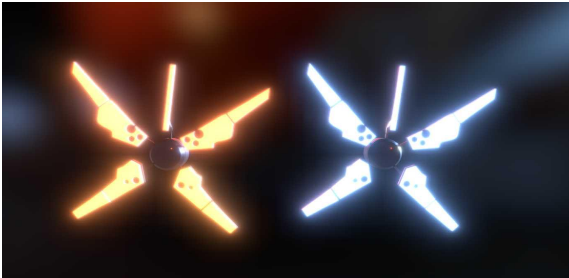
شکل ۳. ادرادک آبی در موقعیت معمولی و ادرادک نارنجی در موقعیت هشدار
